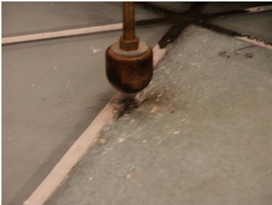
Bild 7: Nach Versuchsdurchführung ist auch der Verbruch der äußeren Glasscheibe ersichtlich. (Personengefährdung) Quelle: Universität der Bundeswehr München
