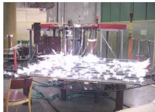
Bild 2 Sprühwirkungen infolge einer Blitzstromekopplung bei einer Blechschindeldeckung Quelle: Brauner, G. Pacher, W. Pigler, F.: Blitzschutz durch Metaldächer. Elektrotechnik und Informationstechnik (e & i). Heft 7/8, 2004
