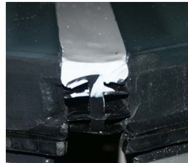
Bild 12: Detail der Fugenausbildung mit den brennbaren Dichtungsmaterialien, welche in Folge der Temperaturerhöhung um die Fangspitze keine Entzündungserscheinungen zeigte.
